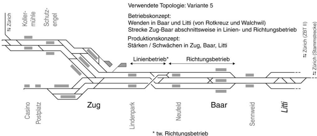
Abb. 20: Betriebs-, Produktions- und Infrastrukturkonzept Horizont „übermorgen“
