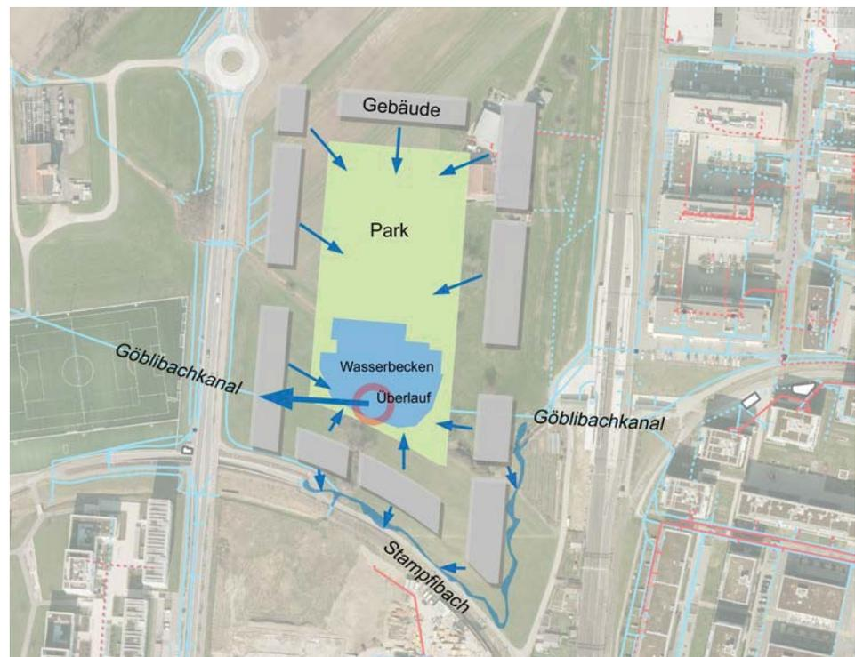
Abbildung 4: Entwässerung Meteorwasser
