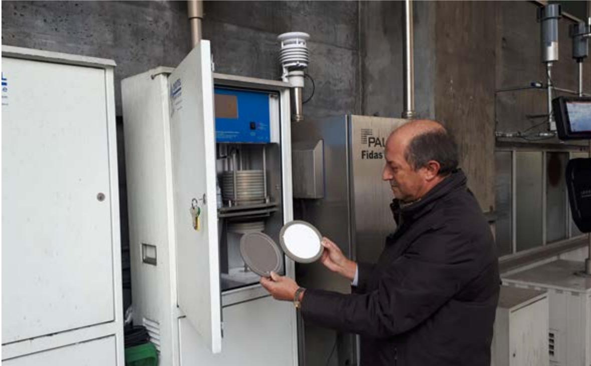
Ein Experte des BAFU prüft die Feinstaubfilter der NABEL-Messstation Bern Bollwerk. Das Nationale Beobachtungsnetz für Luftfremdstoffe (NABEL) misst die Luftverschmutzung an 16 Standorten in der Schweiz.
