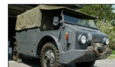
**Saurer 4MH:** 1945-85 eingesetzt. 4MH=4-Rad-Fahrzeug, Militärausführung, Heckmotor. Als Schleppfahrzeug für 7,5 cm Haubitzen entwickelt
