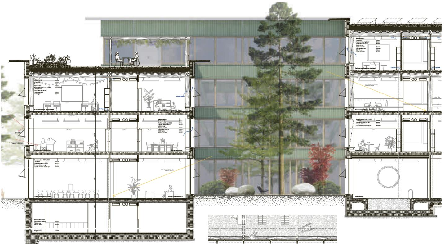
HPS Fassadenschnitt mit Grundriss und Ansicht, Mst. 1:200 (verkleinert)
