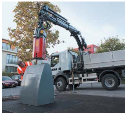
Unterflursammelstelle Menzingen: Andocken des Krans an den Haken der Einwurfsäule
