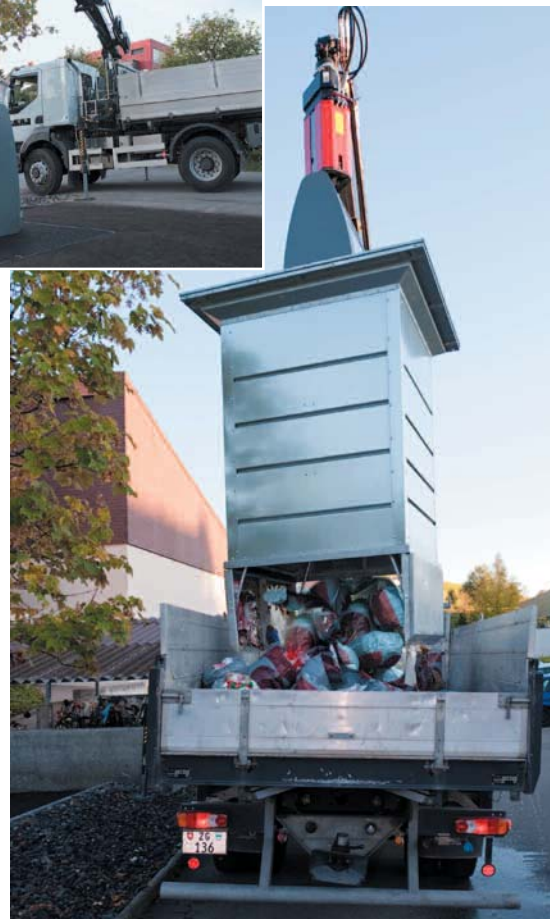
Unterflursammelstelle Menzingen: Leeren des Unterflurcontainers
