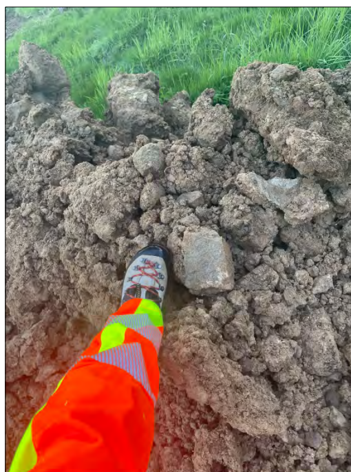
Sandstein (kantig, angewitterte Oberfläche) und Kies (umschlossen von Matrix)
