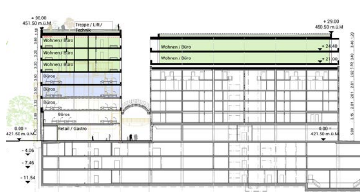
Abb.: 21 Schnitt zentraler Bau
