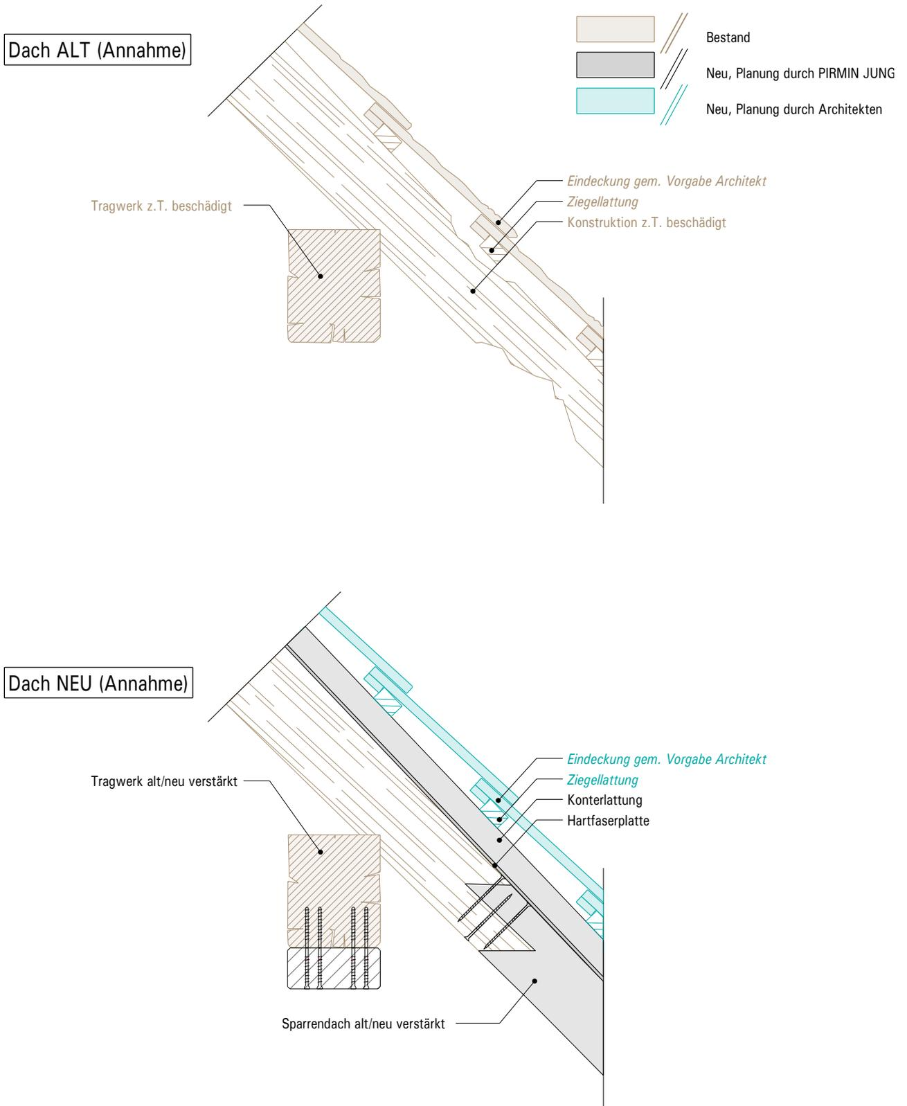
Details basieren auf Annahmen! Die effektive Konstruktion sowie der effektive Zustand sind am Bau zu prüfen!
