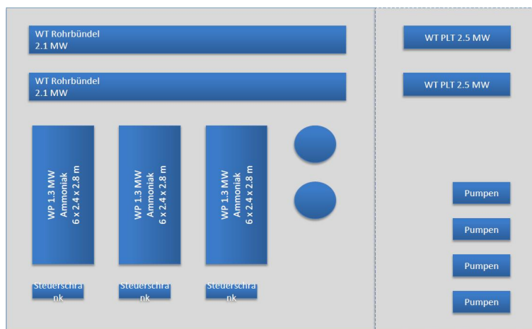
Abbildung 3: Zentralenleitung bei Seewasserfassung (Platzverhältnisse).
