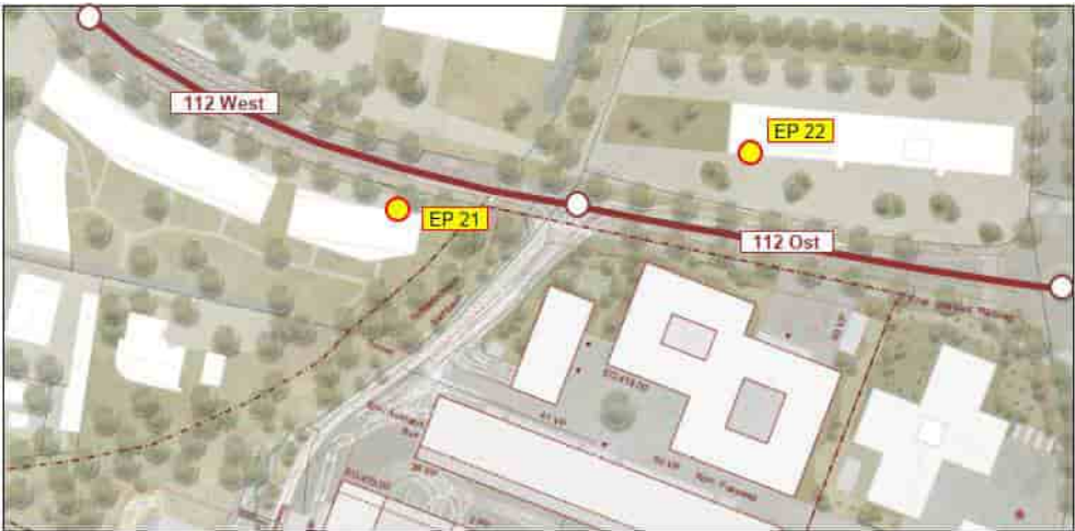
Abbildung 8: Strassenabschnitte und Empfangspunkte Strassenverkehrslärm [4]
