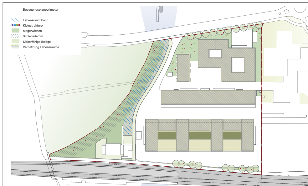
Richtprojekt Bebauungsplan An der Aa II: Ökologie und Nachhaltigkeit (Aufwertung des Schleifendamms, offengelegter Siehbach).
